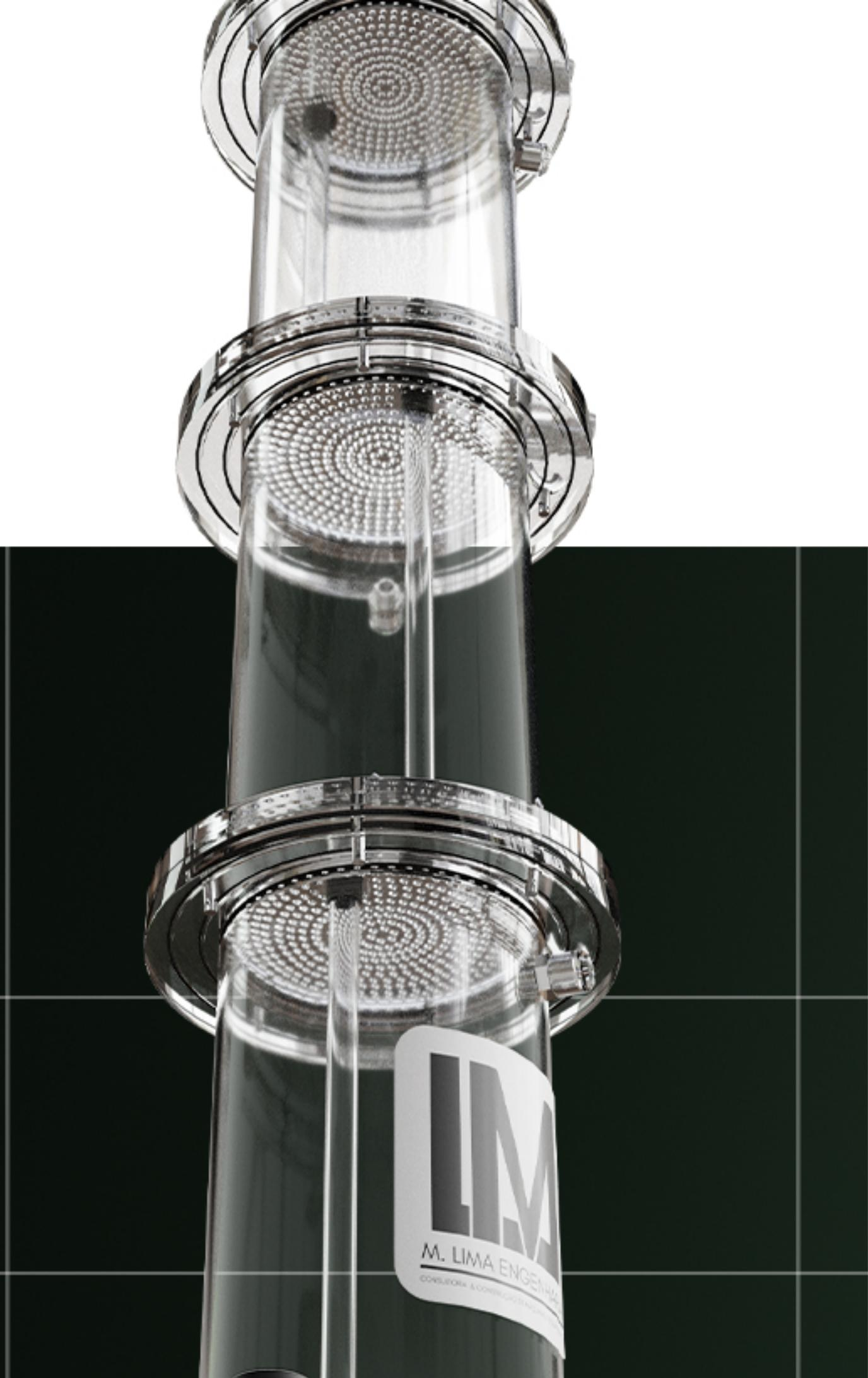
Dentro de um casco cilíndrico são posicionados suportes sobre os quais são inseridos os recheios. Esses possuem a função de aumentar a área de contato entre as duas fases, de maneira a propiciar um maior transporte de massa. Sobre o leito formado pelo recheio são posicionados distribuidores de líquido, dispositivos que evitam a formação de caminhos preferenciais para o líquido por meio da irrigação efetiva dos recheios.
